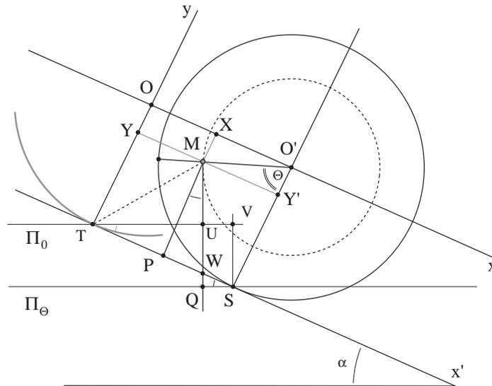
FIG. 2 – Mouvement du centre de gravité du cylindre
